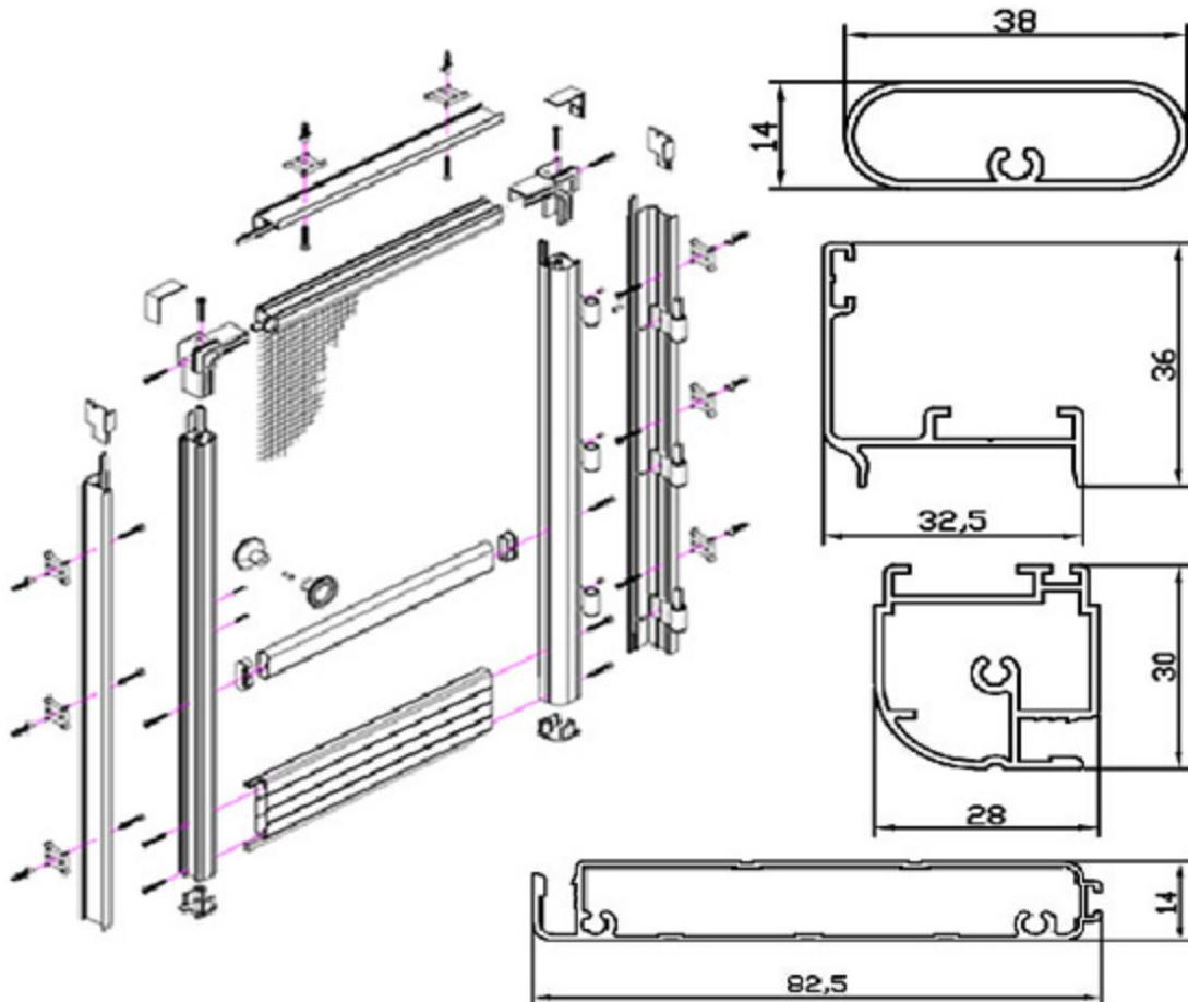
Распашная москитная система ARAKNIS - рекомендуется монтаж только в проем. Важно учесть, при замере глубину проема и при монтаже световой проем перекроется на размер профиля.
