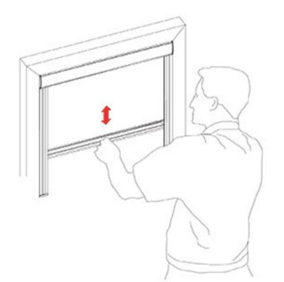
! Если при опускании шторы ткань заклепками цепляется за направляющие, то следует установить дистанционные подкладки под крепления направляющих, чтобы уменьшить размер между ними.
